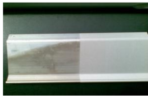
Recuperación de perfiles por defectos de "manchas de agua"
