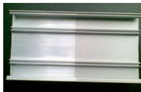
Recuperación de perfiles por defectos de "rayas de matriz"
